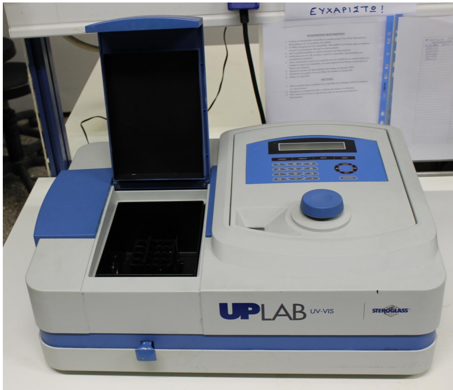
Φωτόμετρο μονής δέσμης Steroglass UPLAB UV-Vis
