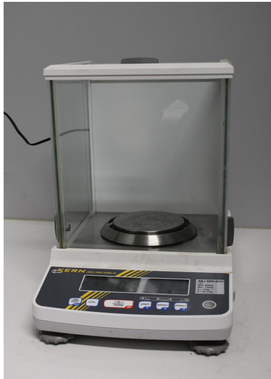
Ζυγός ακριβείας Kern abj-nm/abs-n
