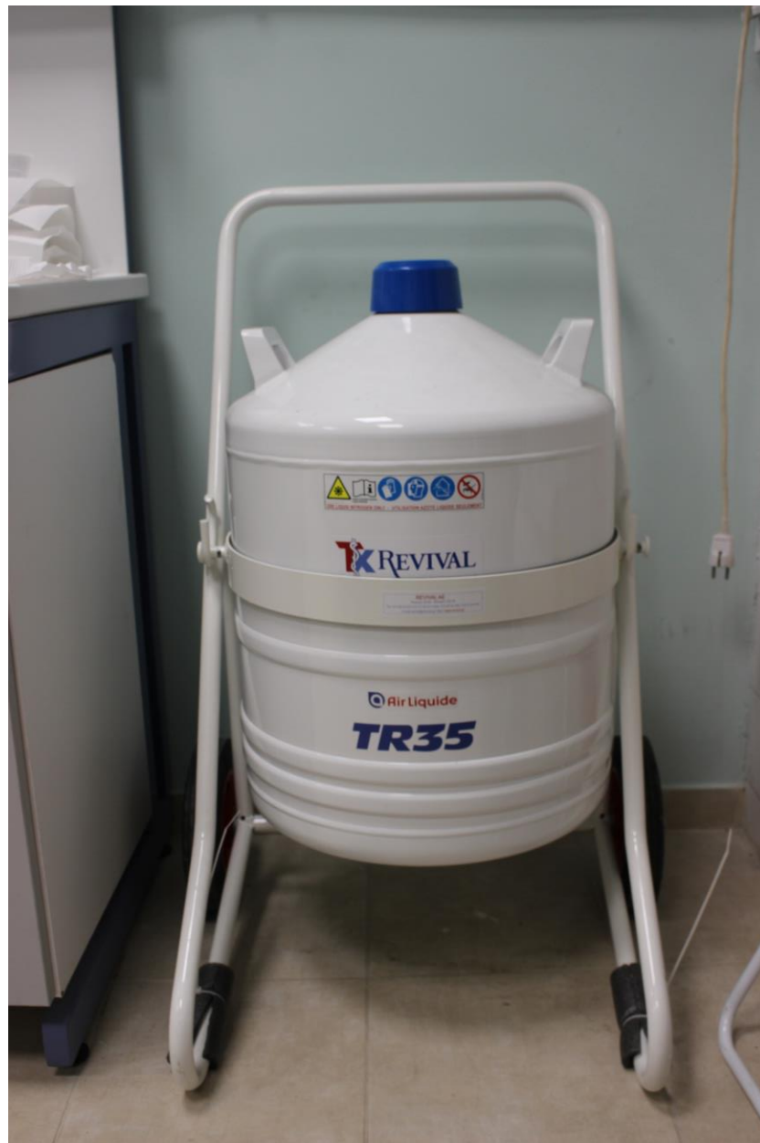
Δοχείο μεταφοράς και αποθήκευσης υγρού αζώτου
