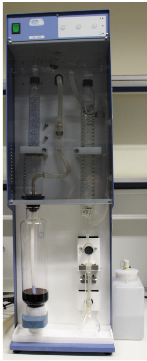
Οινολογικός αποστακτήρας Selecta DE-1626 για τον προσδιορισμό της αιθυλικής αλκοόλης και της πτητικής οξύτητας
