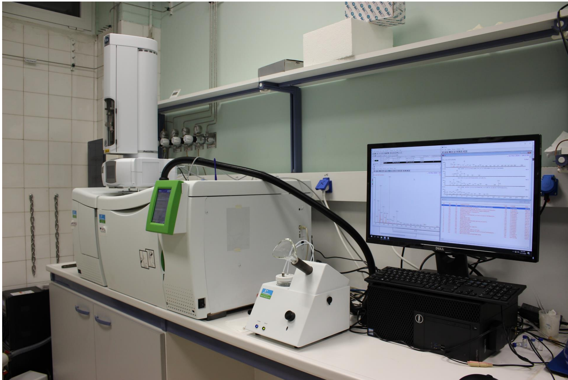
Αεριοχρωματογράφος Perkin Elmer Clarus 590 με ανιχνευτή Clarus SQ 8 S, Ολφакτομετρία SNFR Olfactory Port (GC-O) και αυτόματα δειγματολήπτη HTA
