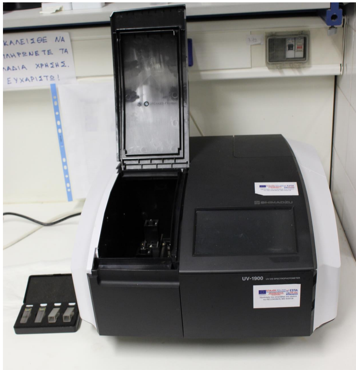
Φωτόμετρο διπλή δέσμης Shimadzu UV-1900 UV-Vis
