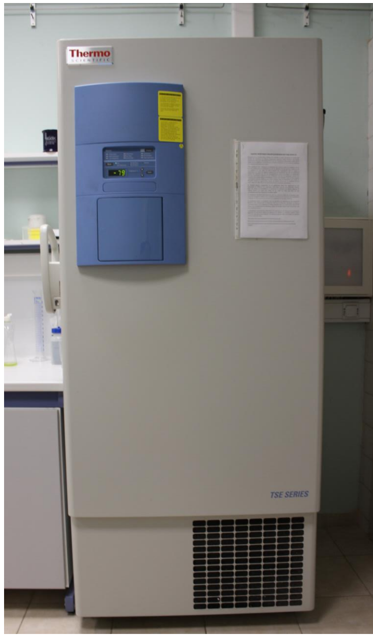
Εργαστηριακού τύπου καταψύκτης Thermo Scientific TSE -80C Series
