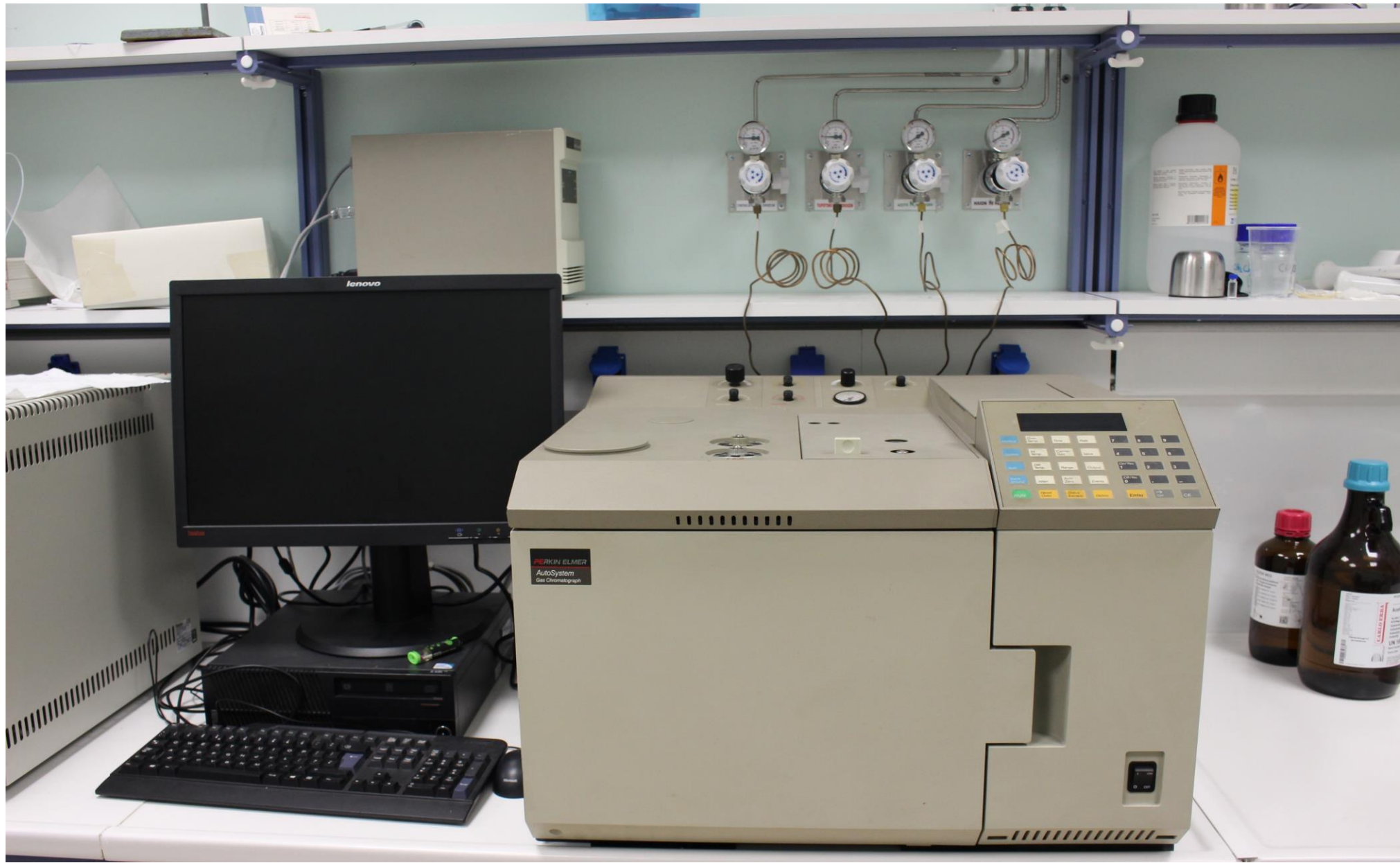
Αεριοχρωματογράφος Perkin Elmer AutoSystem με ανιχνευτή FID και ECD
