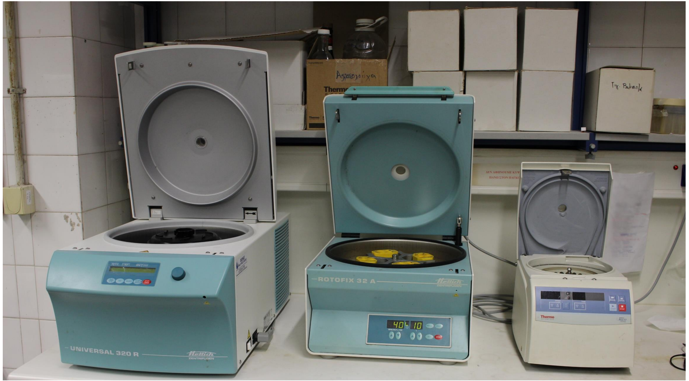
Φυγόκεντροι: Ψυχόμενη Hettich Universal 320 R, Hettich Rotofix 32 A & Thermo Scientific Heraeus Pico 17 microcentrifuges
