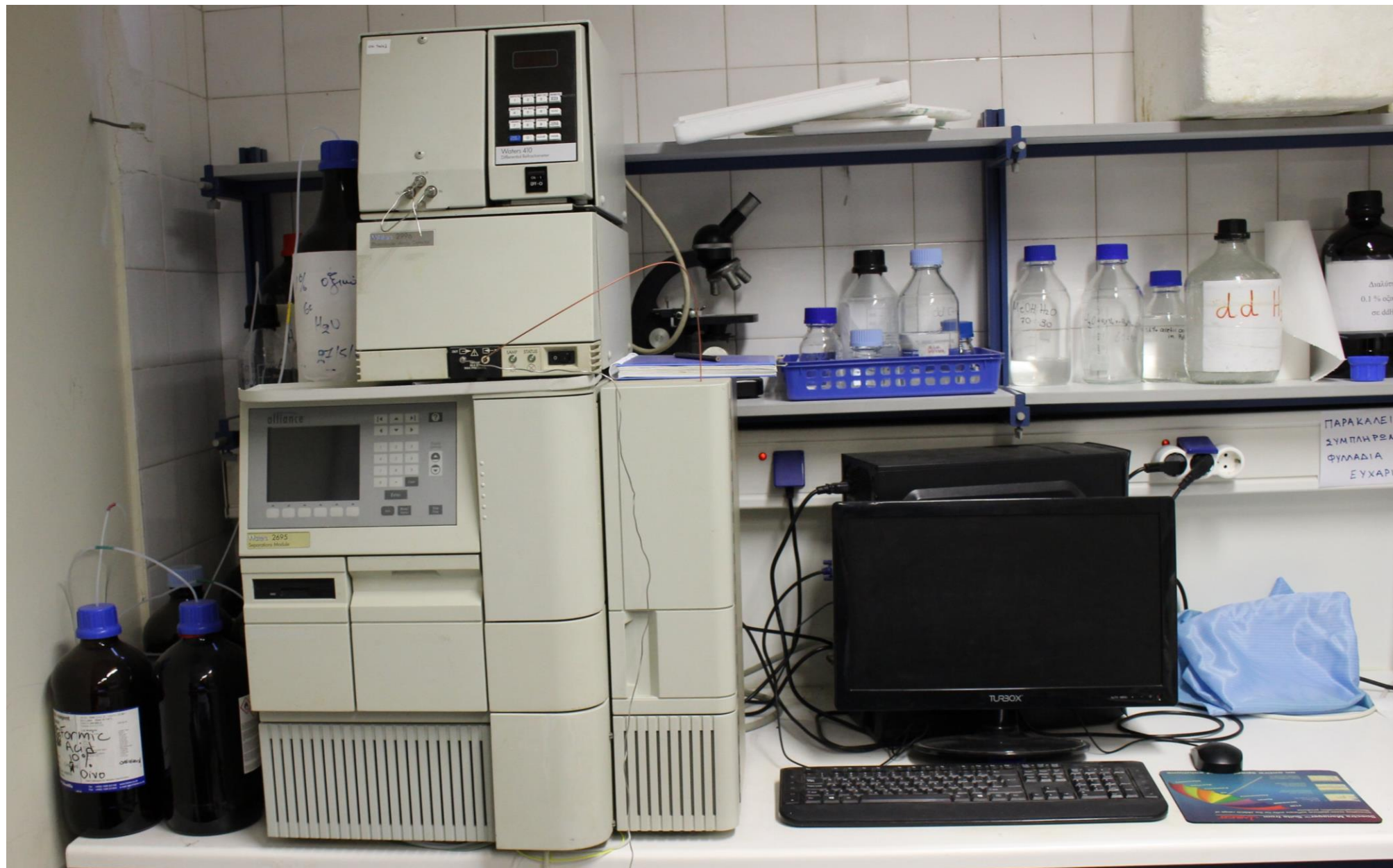
Υγροχρωματογράφος Waters 2695 Alliance με ανιχνευτή UV-Vis και RID
